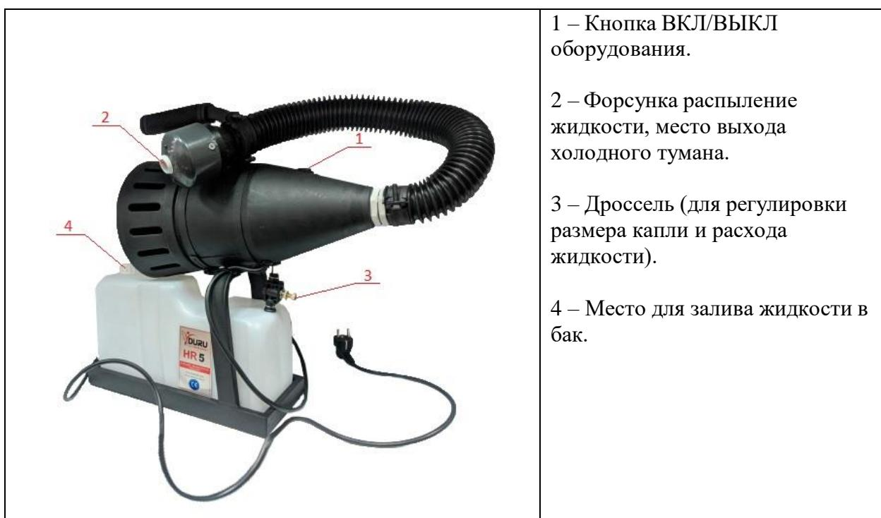
Принцип работы генератора холодного тумана со шлангом заключается в том, что электродвигатель со специально разработанной форсункой приводит жидкость в дисперсное состояние, мельчайшие капельки вещества сильным потоком воздуха распыляются в окружающие пространство. Размер капли и расход жидкости можно регулировать с помощью дросселя, который расположен на лицевой стороне аппарата.
